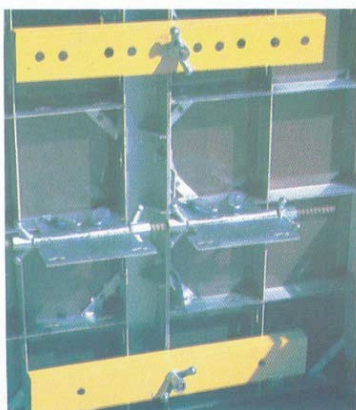
Montagem do conjunto do Painel de Regulação
